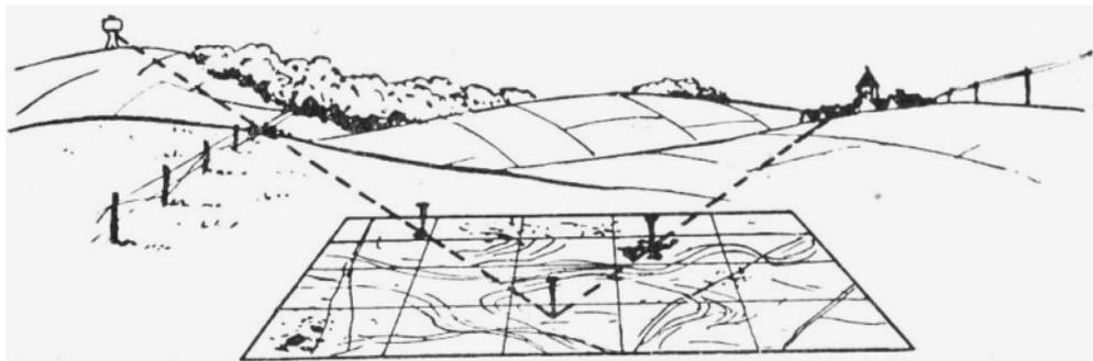
Sur le dessin, on a représenté deux lignes de visée se recoupant sur la carte posée à même le sol. Si l'on possède un rapporteur, on pourra l'utiliser pour reporter les angles sur la carte.
